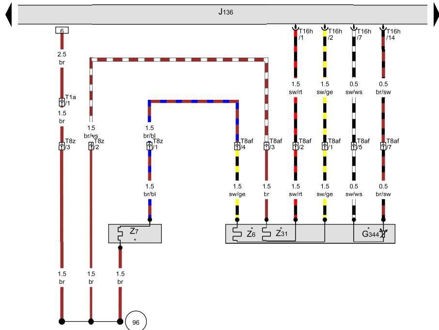
左前座椅温度传感器, 带记忆功能的座椅调节和转向柱调节装置, 可加热式驾驶员座椅, 可加热驾驶员座椅靠背
