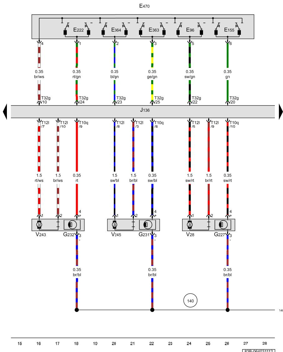
驾驶员座椅调整操纵单元, 带记忆功能的座椅调节和转向柱调节装置, 驾驶员座椅纵向调节电机, 驾驶员座椅倾斜度调节电机, 驾驶员座椅高度调节电机
